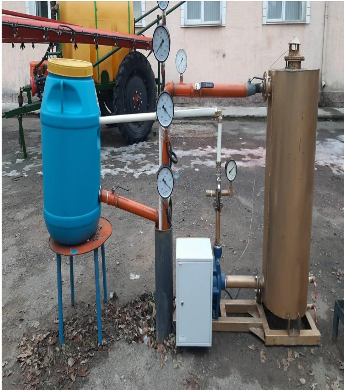
Рисунок 4.3 - Общий вид наземной части стенда для проведения экспериментальных исследований и лабораторных испытаний экспериментального образца усовершенствованной гидроструйной насосной установки
