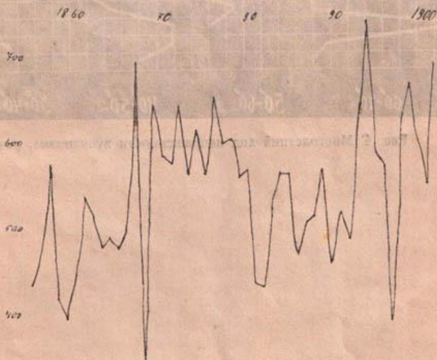
Рис. 2. Многолетний ход величины годовых осадков в Москве. В конце 60-х и в середине 90-х годов отчетливо видны два скачка, соответствующие max. 33-летней волны.
