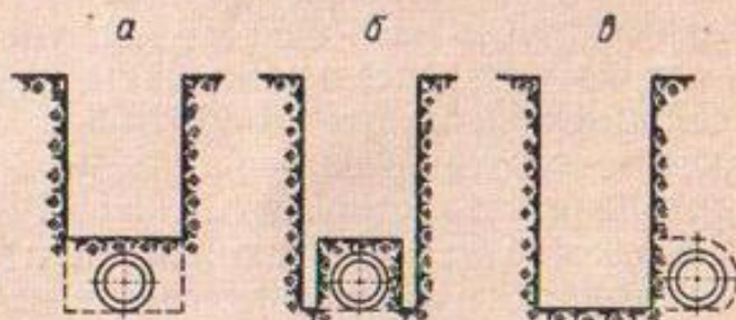
Рис. 83. Способы рытья траншей для перекладки дрен:
