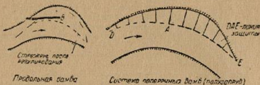
Рис. 13. Система продольных и поперечных дамб (полузапруд).
