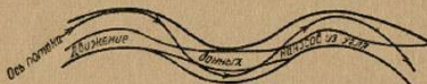
Рис. 4. Движение донных наносов при изгибе реки, по опытам.
