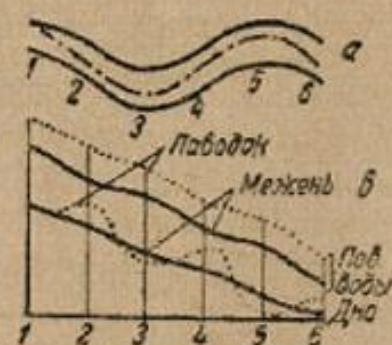
Рис. 2. План (а) и продольный разрез (z) изогнутого участка реки при паводке и межени.
