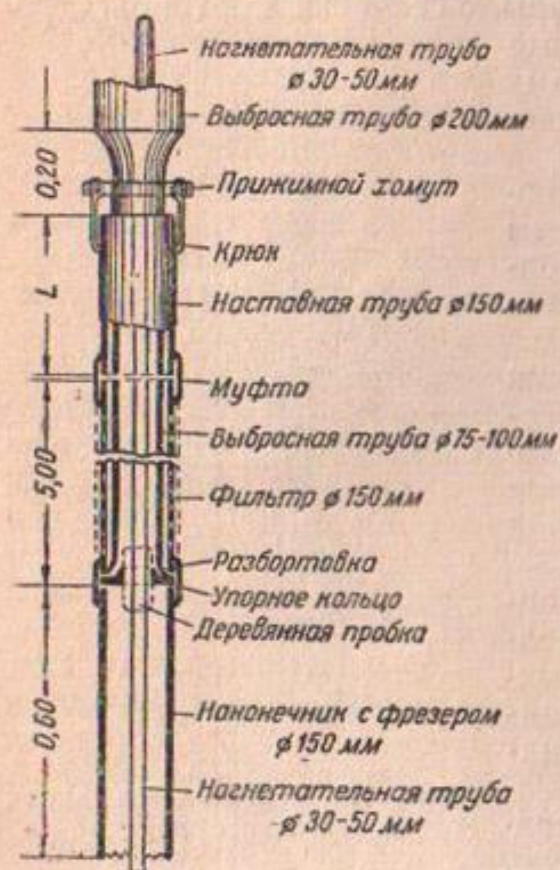
Фиг. 74. Трубчатый колодец „Союзводстроя“
