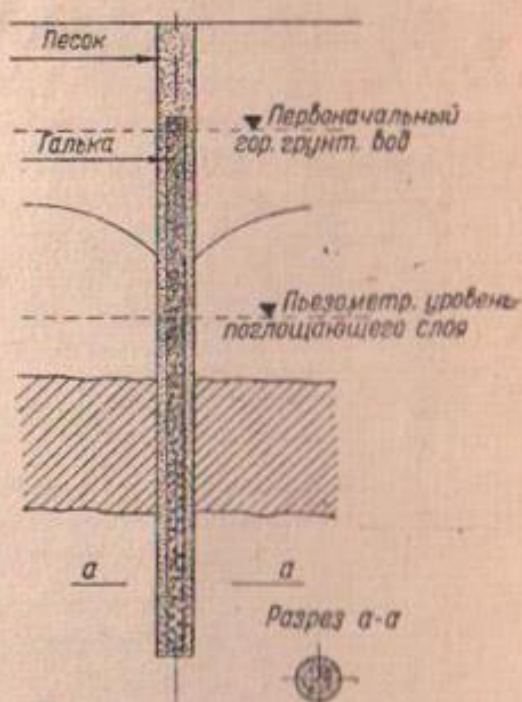
Фиг. 83а. Простейший поглощающий колодец
