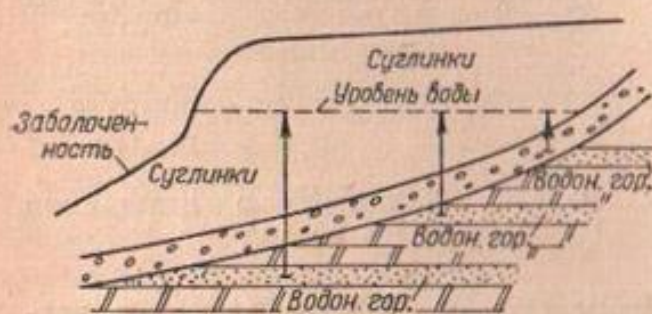
Фиг. 8. Заболачивание склона напорными водами
