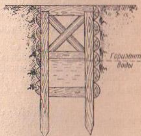
Фиг. 18. Дренажный лоток свайного типа усиленной конструкции
