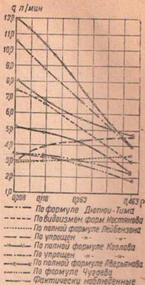
Фиг. 52. Кривые дебита незатопленных одиночных дрена в зависимости от их положения над водоупором для условий бассейна
