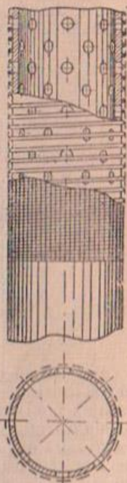
Фиг. 78. Простейший фильтр с сеткой
