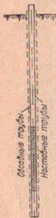
Фиг. 76. Схема трубчатого колодца
