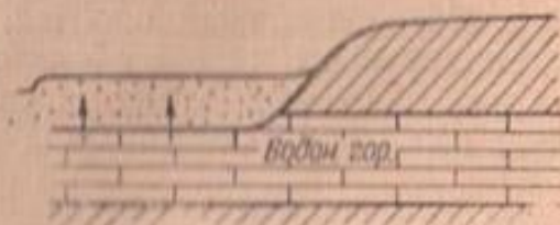
Фиг. 7. Подтопление напорными водами
