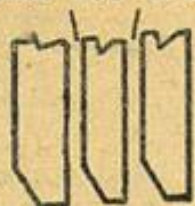
Рис. 147. Применение досок без гребней и пазов вместо шпунтов
