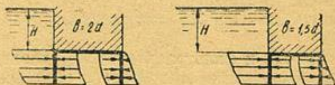
Рис. 158. Статические условия работы шпунтовых рядов в двухшпунтовом контуре при различном соотношении ширины флютбета и глубины шпунта
