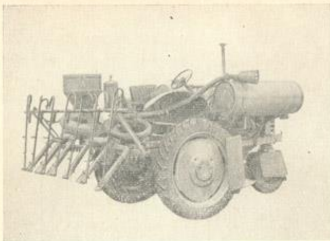
Рис. 18. Опыливатель-опрыскиватель ОУН-4-6А (общий вид).
