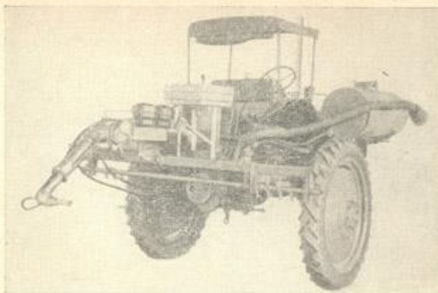
Рис. 20. Аэрозольное приспособление АП (общий вид).
