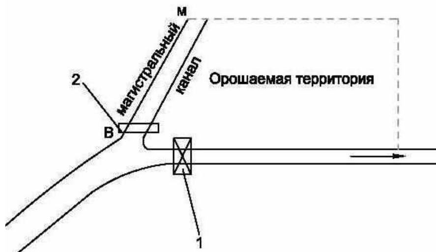
Рис.3.3.28. Схема плотинного водозабора: 1 - плотина, 2 - головной регулятор
