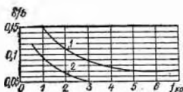
Рис. 27.4. График для предварительного определения относительной толщины \delta/b обделки безнапорного туннеля
