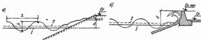
Рис. 13.15. Схемы к определению отметки гребня плотины
