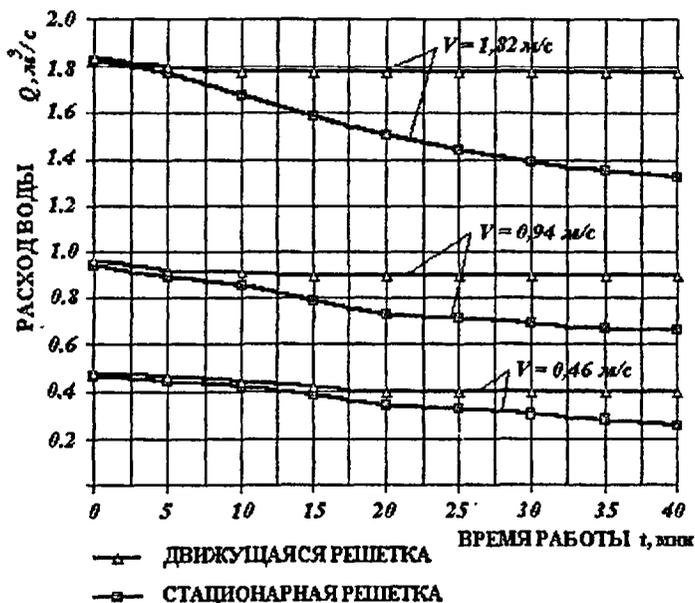
Рисунок 7 – Сравнительная характеристика стационарной и самоприводной движущейся решеток по пропускной способности.
