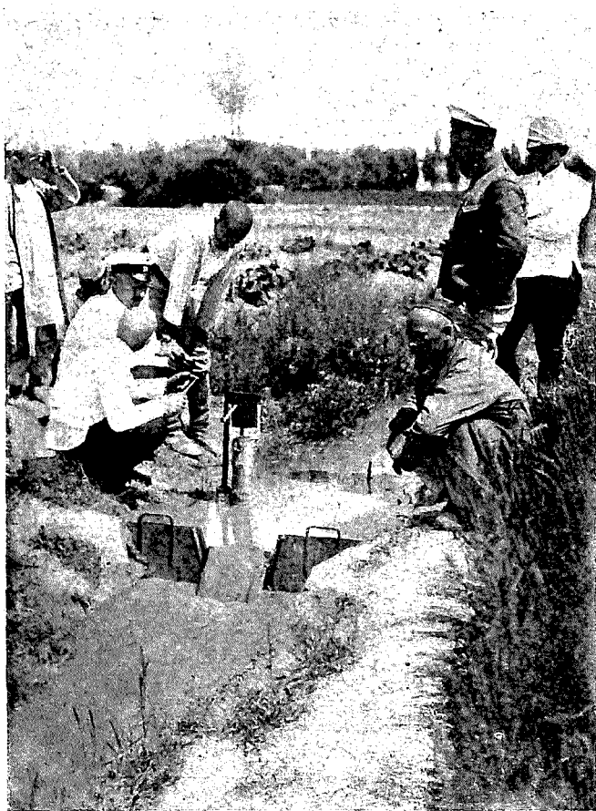
Рис. 43. Лимниграфъ системы инж. Н. В. Мас- тицкаго. Шураханъ. Фот. К. Ф. Шмыкова. 26—VII—14.
