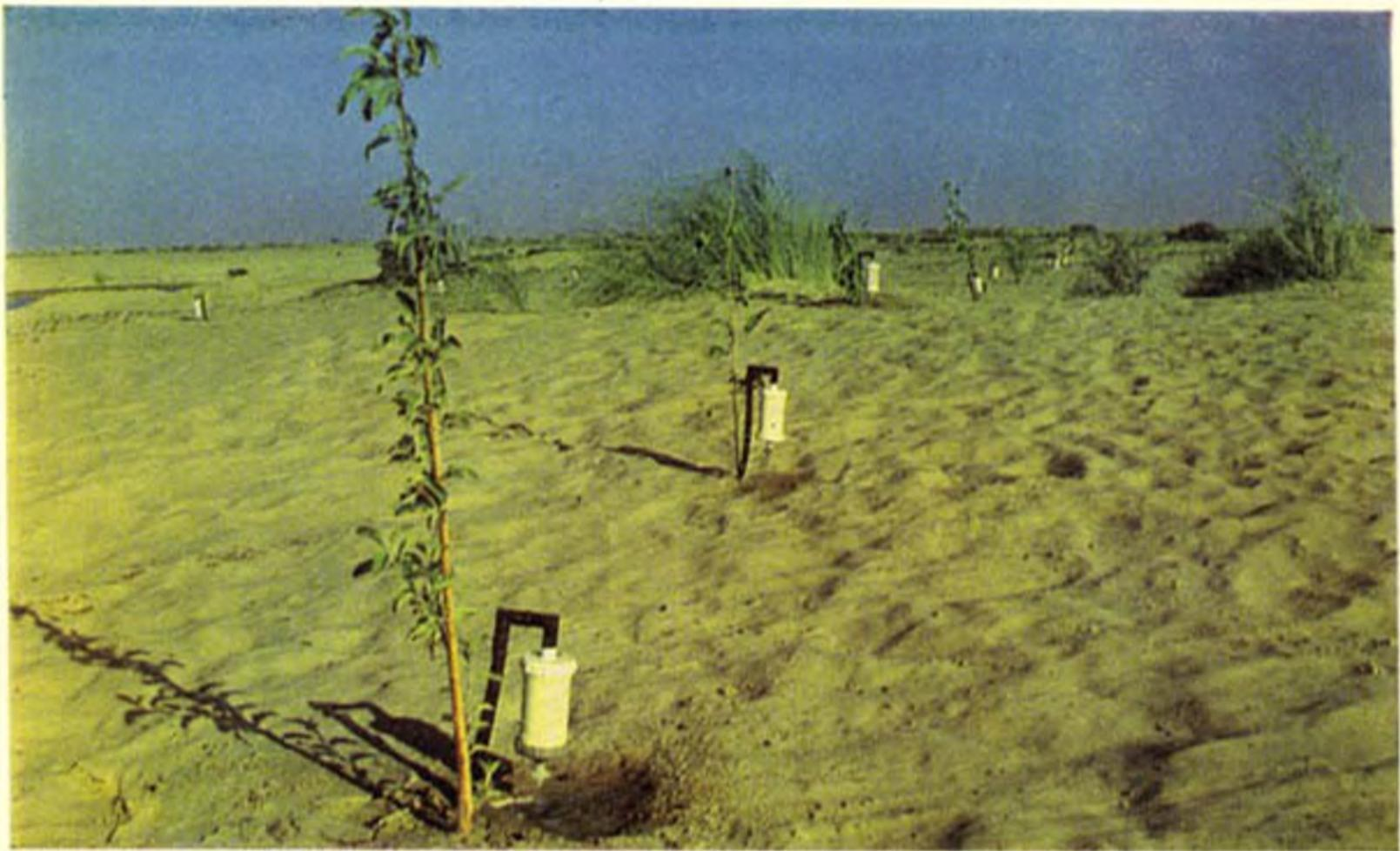
Опытный участок капельного орошения на песках. Хорезм.
