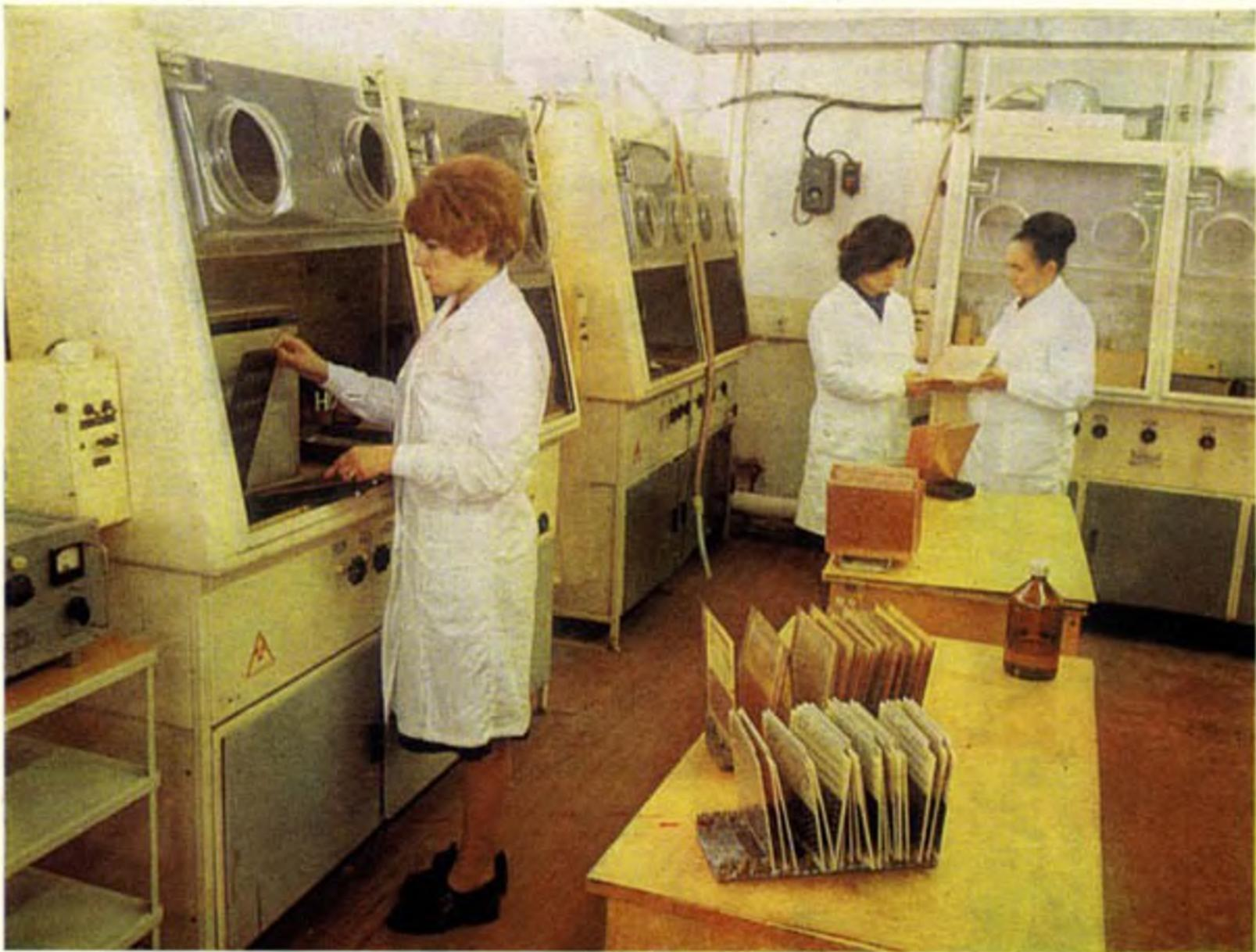
Лаборатория по изготовлению и испытанию плит печатного монтажа.
