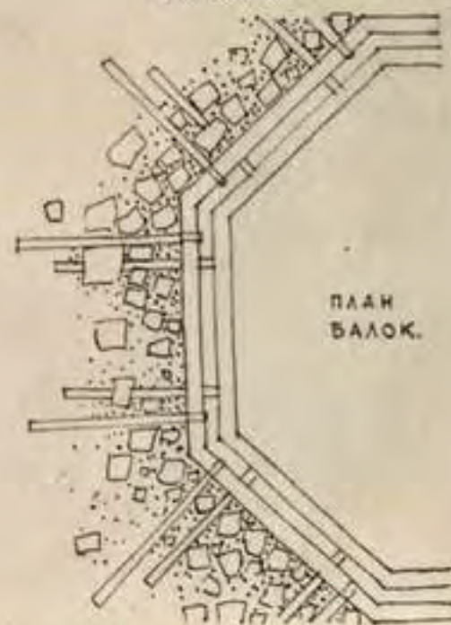
ПЛАН ПЛАН БАЛОК. КОНСТРУКЦИЯ УРГУТСКОГО ХАУЗА ИЗ ДЕРЕВА
