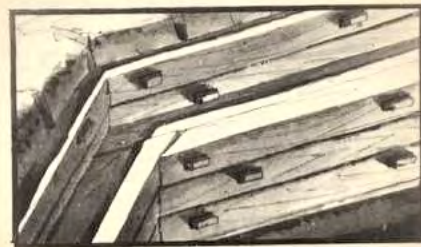
КОНСТРУКЦИЯ УРГУТСКОГО ХАУЗА ИЗ ДЕРЕВ
