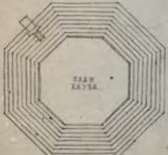
КОНСТРУКЦИЯ БУХАРСКОГО ХАУЗА ИЗ КАМНЯ.
