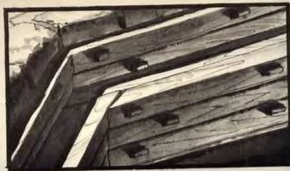
ПЛАН ПЛАН БАЛОК. КОНСТРУКЦИЯ УРГУТСКОГО ХАУЗА ИЗ ДЕРЕВА
