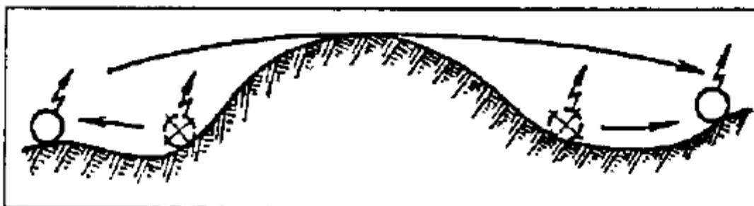
Рис 3. Развертывание радиостанций для передачи сигналов через куполообразную возвышенность (большая часть сигнала теряется в атмосфере).
