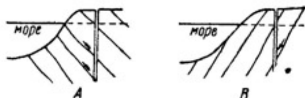
Рис. 104. Схематический разрез, показывающий значение падения трещин в отношении попадания морской воды в колодцы.
