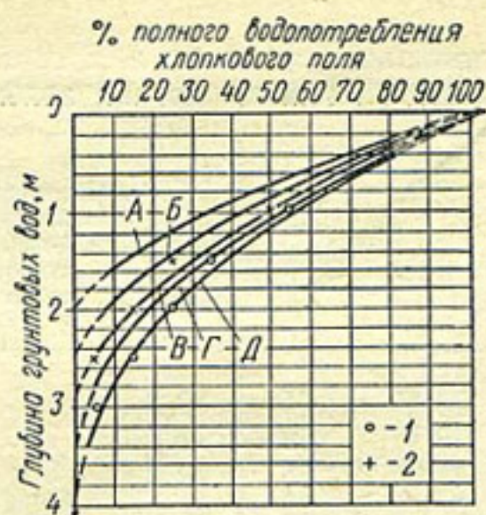
Рис. 11. Использование грунтовых вод в общем водопотреблении: А, Б, В, Г, Д — индексы почв по водопроницаемости; 1 — тяжелые почвы; 2 — легкие почвы.
