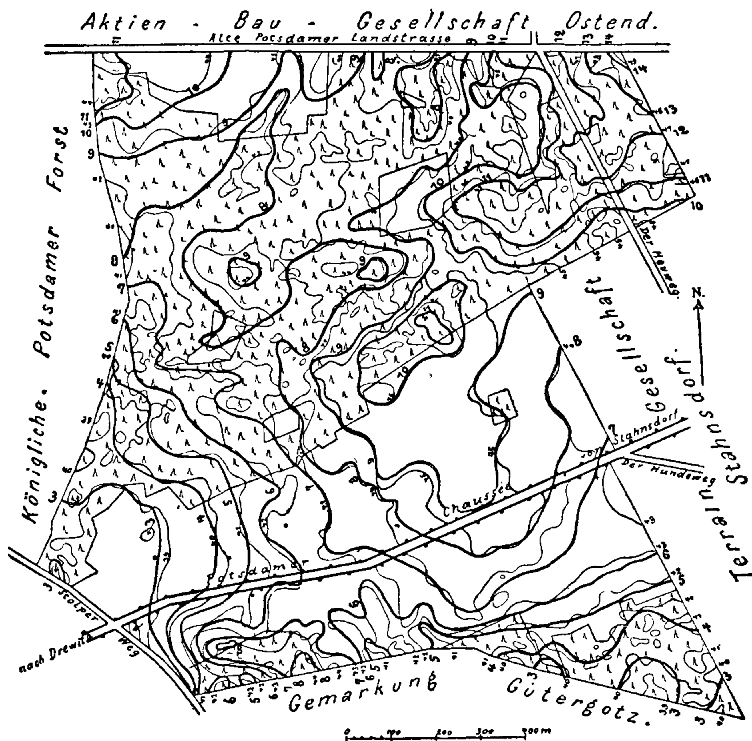
Фиг. 57. Мощность покровныхъ слоевъ надъ грунтовой водой въ области центральнаго кладбища у Штансдорфъ, изображенная посредствомъ горизонталей черезъ 1 метръ. Масштабъ 1 : 15000.
