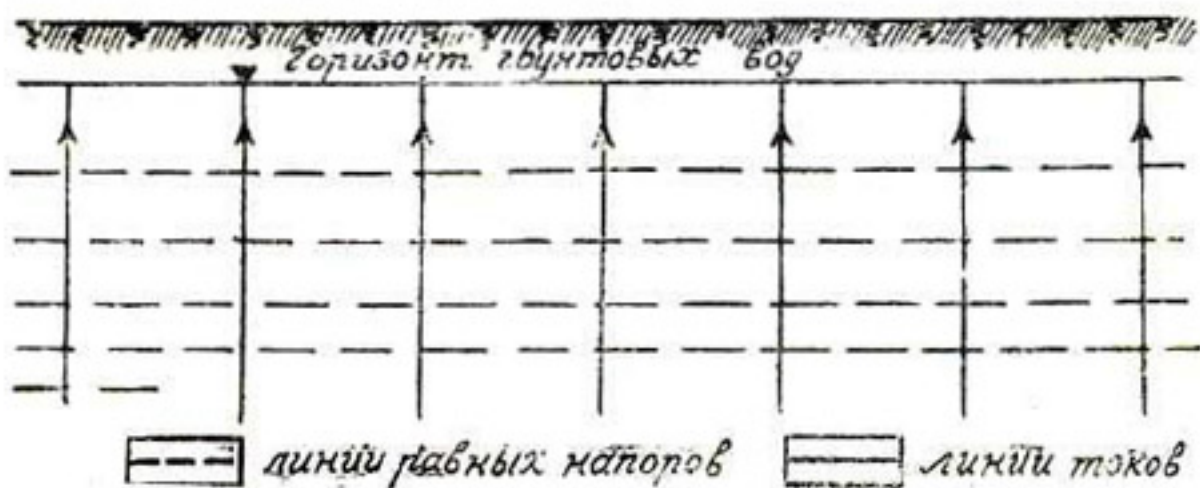
Рис. 12. Схема движения грунтовых вод при напорном питании их в естественных бездренажных условиях.
