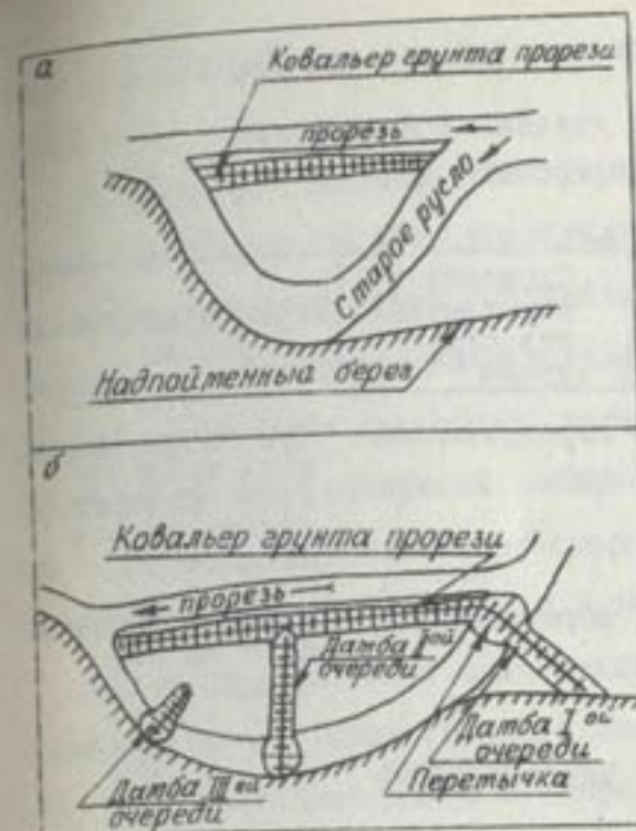
Рис. I. Схемы производства русловыправительных работ на р. Амударье: *
