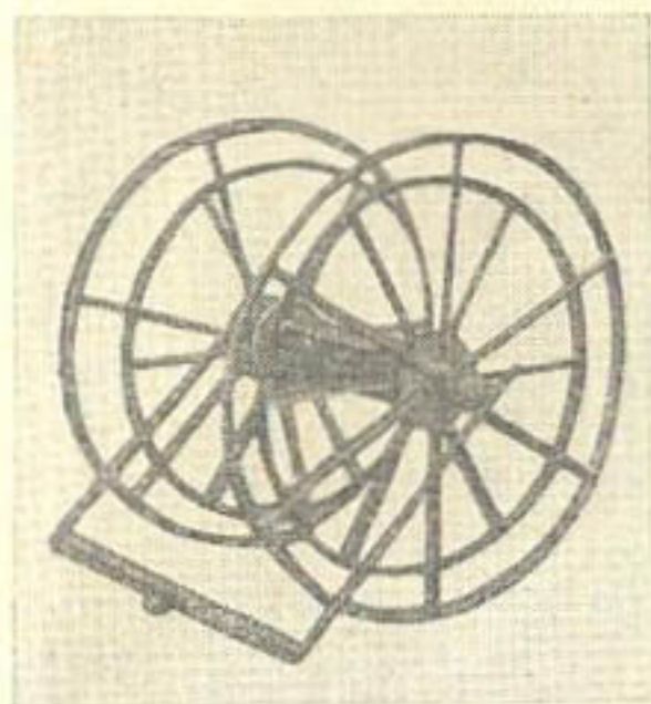
Рис. 48. Двойная катушка для полумеханизированной укладки, сборки и перемещения гибких трубопроводов со съемной тягой для буксировки.
