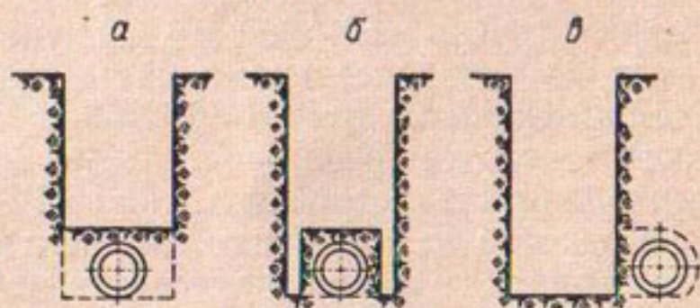
Рис. 83. Способы рытья траншей для перекладки дрен:
