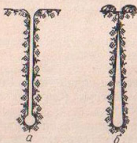
Рис. 4. Земляной дренаж: а — кротовый и б — щелевой.
