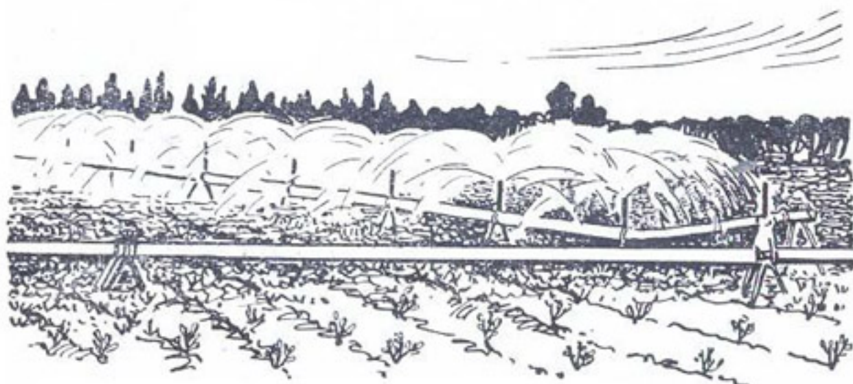
Рис. 11. Короткоструйная дождевальная установка КДУ-55М в работе.
