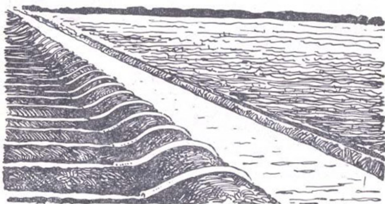
Рис. 5. Выпуск воды в поливные борозды сифонами из оросителя с большой пропускной способностью.
