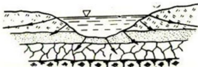
Рис. 8-8. Схема фильтрации через дно и борта водохранилища.
