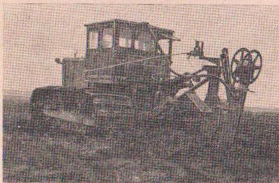
Рис. 18. Дреноукладчик ДПБН-1,8 с рабочим органом для закладки труб, формируемых из пластмассовых лент.
