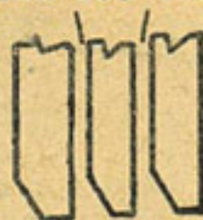
Рис. 147. Применение досок без гребней и пазов вместо шпунтов
