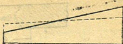
Рис. 44. Распределение нормальных напряжений при отсутствии хвостового утолщения и при его наличии
