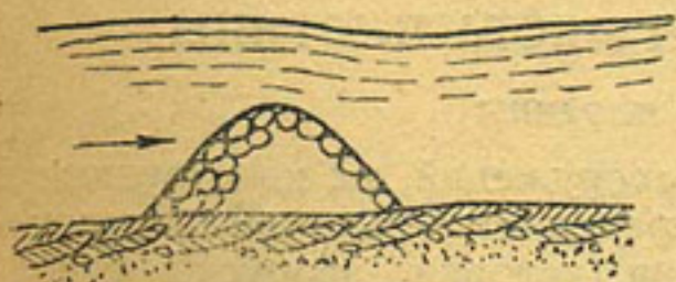
Рис. 195. Первая стадия работы наброски в текущую воду
