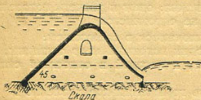
Рис. 92. Полый железобетонный водослив на скале (профиль)
