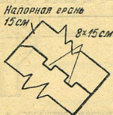
Рис. 54. Рабочий шов напорной плиты плотны Кингздом
