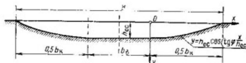
Рис. 54. Безмерный профиль живого сечения канала, рассчитанный по методу влекущей силы:
