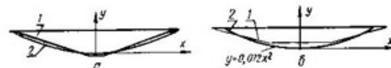
Рис. 57. Безразмерные поперечные профили Куйбышевского канала и канала Волга — Урал (б):
