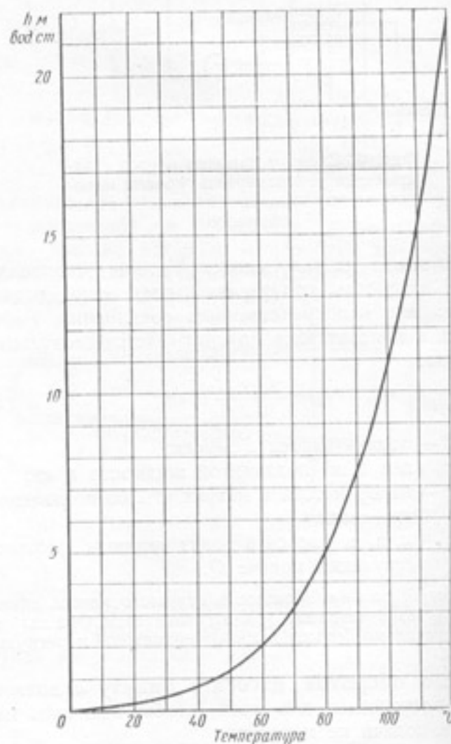
Фиг. 9. Зависимость давления насыщенного водяного пара от температуры, выраженная в м вод. ст. соответствующей температуры.
