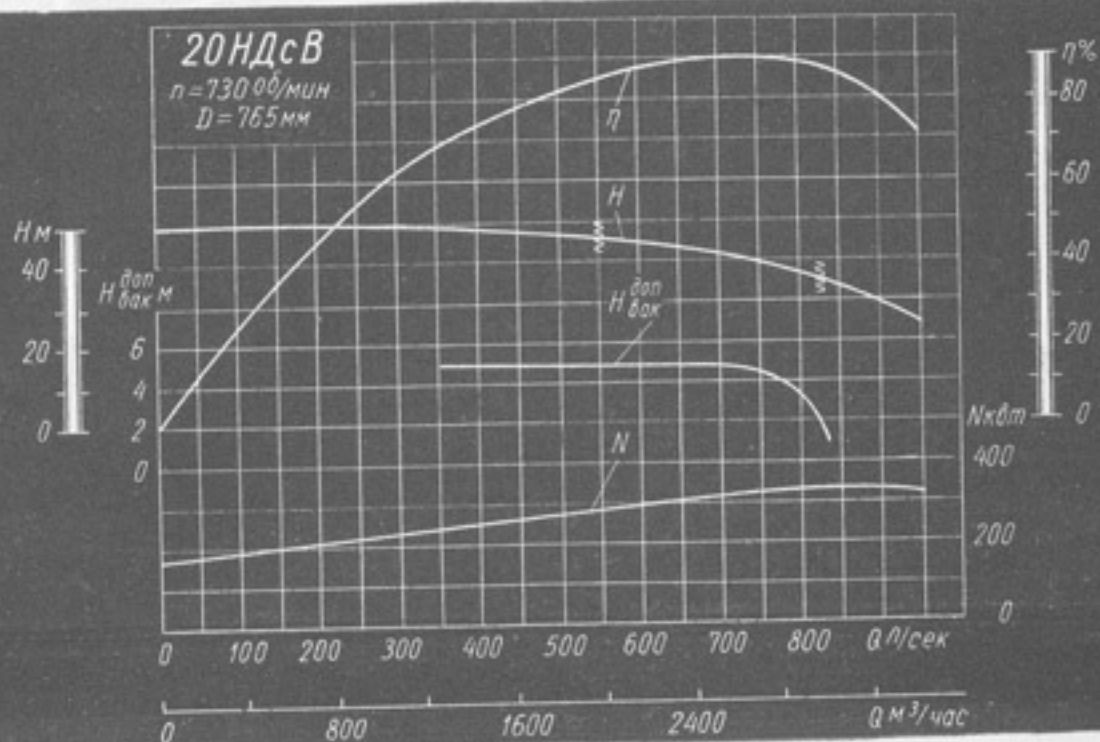
Характеристика насоса 20НДсВ ( n = 730 \text{ об/мин} ).
