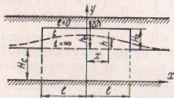
Рис. 17. Схема растекания бугра грунтовых вод.
