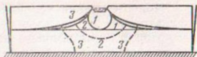
Рис. 57. Схема к расчету перемещения зоны опреснения вблизи оросительного канала при наличии дренажа в условиях неустановившегося движения; — поверхность грунтовых вод; — — — поверхность раздела засоленных и пресных грунтовых вод; 1, 2, 3 — положения во времени.
