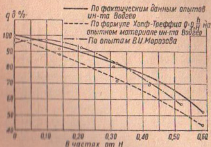
Фиг. 56. Сравнительный график дебита головных дрен в зависимости от их положения над водоупором
