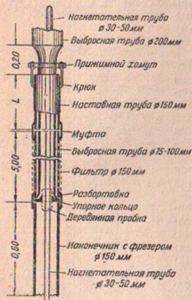
Фиг. 74. Трубчатый колодец „Союзводстроя“
