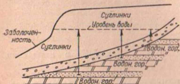
Фиг. 8. Заболачивание склона напорными водами
