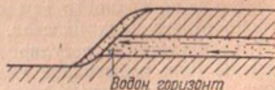
Фиг. 3. Выход грунтового потока в склоне
