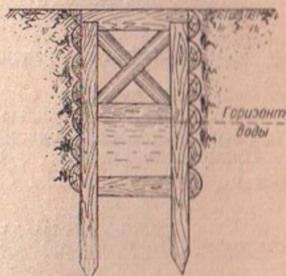
Фиг. 18. Дренажный лоток свайного типа усиленной конструкции
