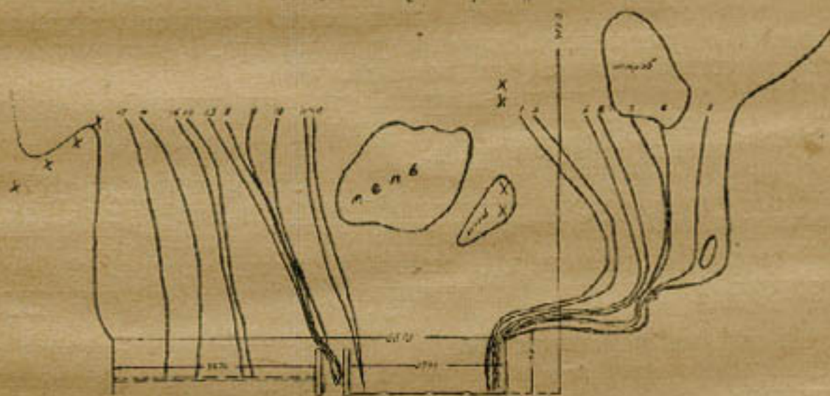
Рис. 5. Схема направления поверхностных струй и состояния русла на 8.VI 34 г. Q = 66,50 \text{ м}^3/\text{сек.}
