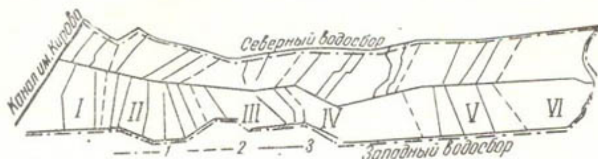
Рис. 1. Схема расположения наблюдательных и эксплуатационных скважин. 1—граница совхоза „Пахта-Арал“, 2—граница отделений совхоза, 3—оронительная сеть; I—отд. „Октябрьское“, II—„Первомайское“, III—им. XXII партсъезда, IV—им. Ильича (центральное), V—„Коминтерн“, VI—им. Дзержинского.
