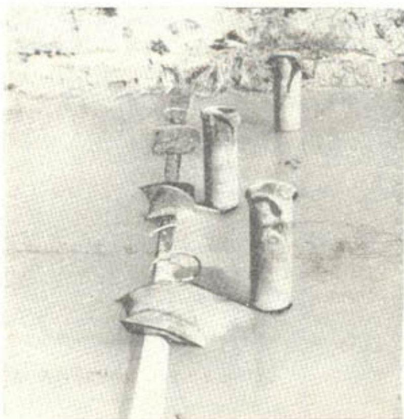
Рис. 6. Присоединение сумок к приборам для измерения фильтрации.
