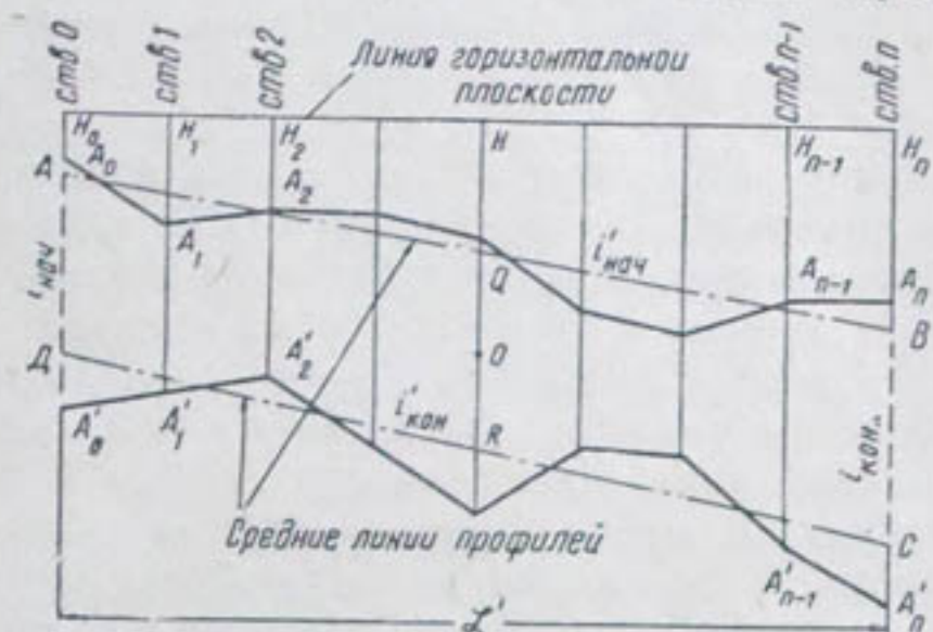
Рис. 2. Профили, построенные по точкам начал и концов средних линий профилей створов: A_0, A_1, A_2, \dots, A_n — точки начал средних линий профилей створов; A'_0, A'_1, A'_2, \dots, A'_n — точки концов средних профилей створов; H_0, H_1, H_2, \dots, H_n — ординаты средних линий; H'_0, H'_1, H'_2, \dots, H'_n — ординаты концов средних линий; HQ — средняя ордината начал средних линий; HR — средняя ордината концов средних линий; HO — ордината центра поля (средняя ордината начал и концов средних линий); ABCD — проектная поверхность, представленная в вертикальной плоскости; i'_{нач} — проектный уклон начальной поперечной линии; i'_{кон} — проектный уклон конечной поперечной линии; i_{нач} — уклон начальной продольной линии; i_{кон} — уклон конечной проектной линии; Z — ширина планируемого участка.
