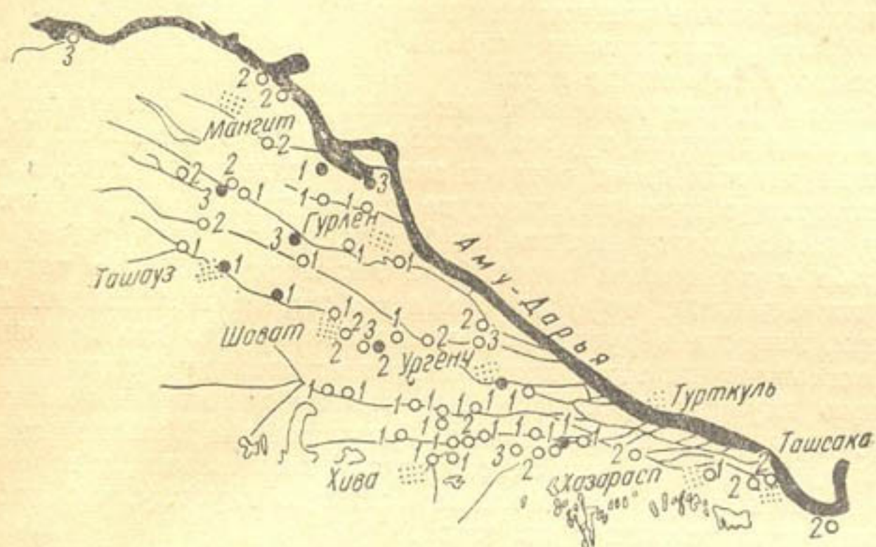
Рис. 8. Схема размещения насосных станций с насосами ПВ-1: а — построенные до 1939 г.; б — намеченные к постройке; 1, 2, 3 — число агрегатов.
