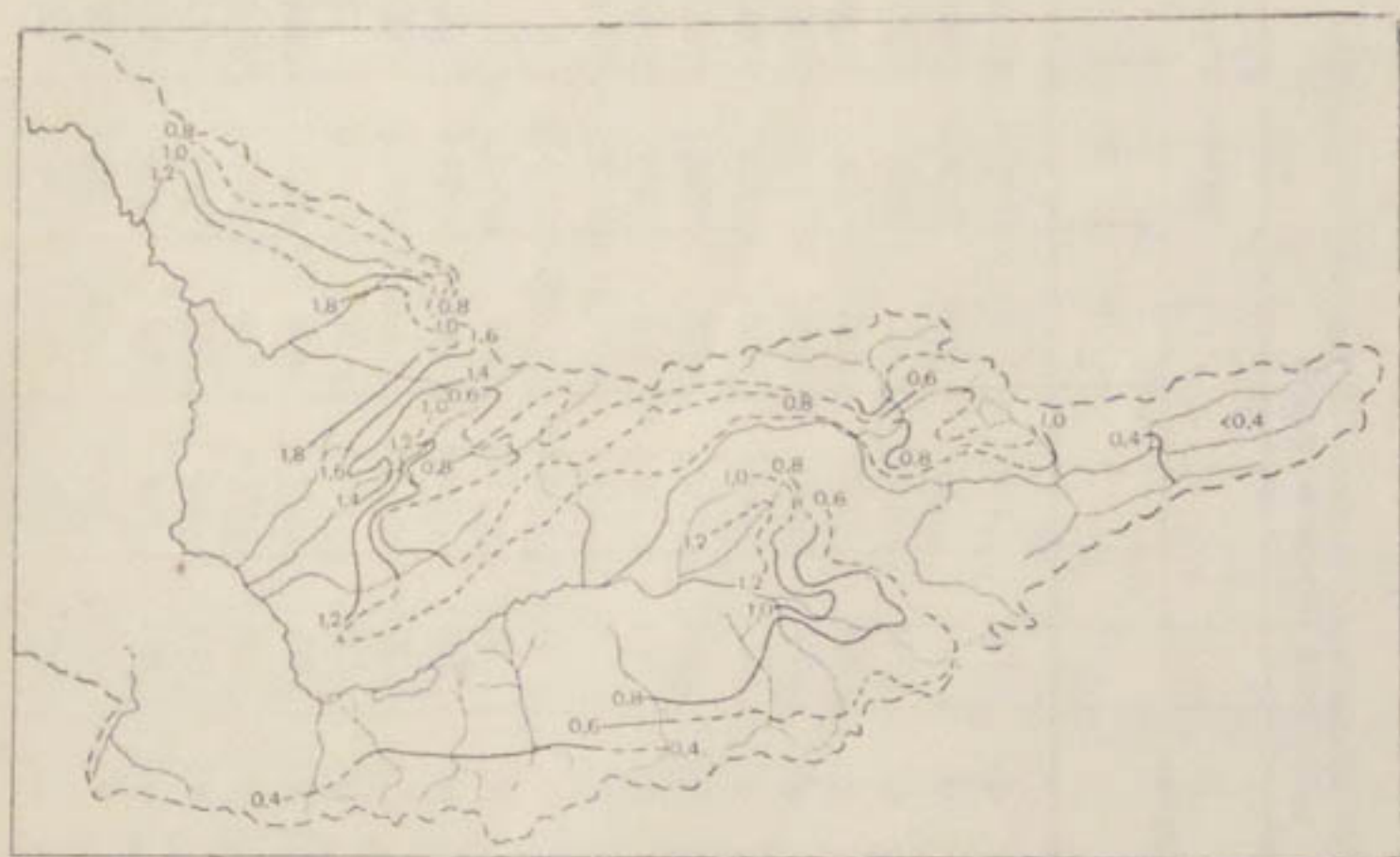
Рис. 20. Схематическая карта коэффициентов вариации средних годовых расходов взвешенных наносов.
