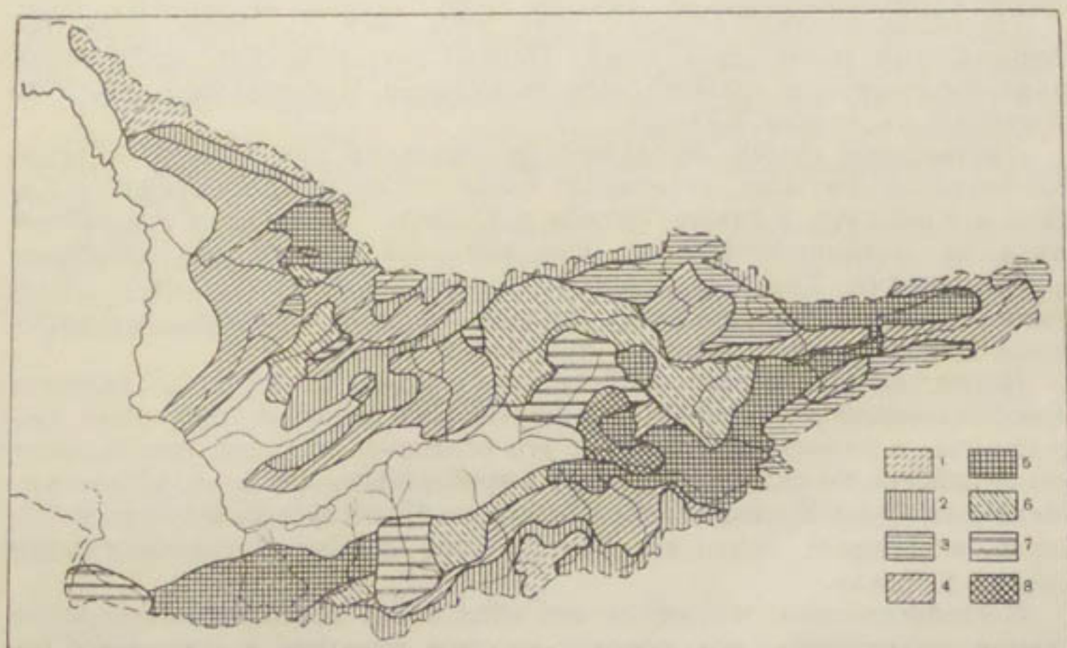
Рис. 15. Схематическая карта модулей стока взвешенных наносов рек бассейна Сыр-Дарьи (г/сек. 1 км 2 ).
