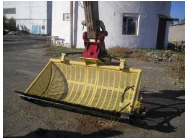
Рис. 2 – Установка нового сменного рабочего органа на экскаватор
